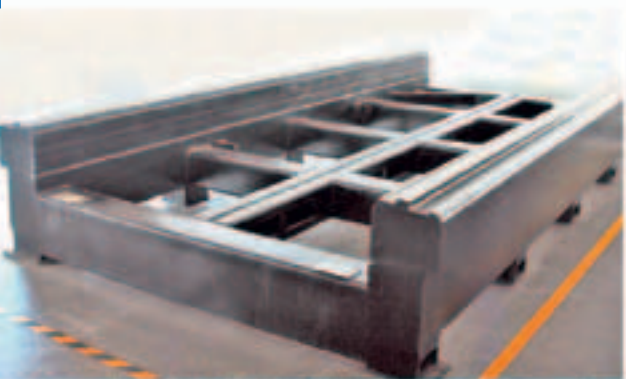
03/ 床身热时效处理 Bed thermal aging treatment
